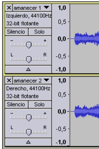
7. Haz clic sobre el botón "X" cerrar situado en el encabezado de la onda del canal **Derecho**. (También se podría hacer eliminando el canal Izquierdo) . De los dos cuadros que muestran la onda sonora será el situado más abajo. Con esta operación se elimina la onda sonora del canal derecho.
