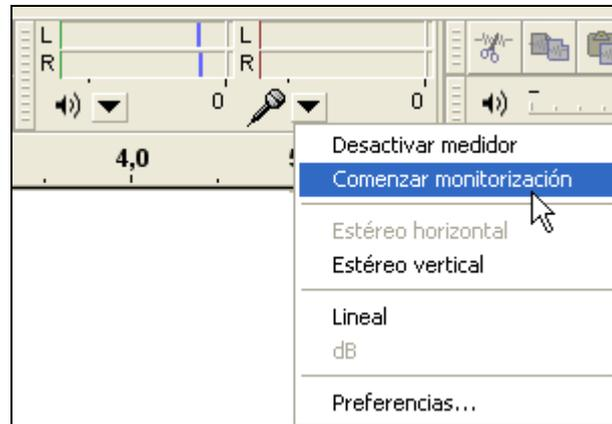
11. Con ello Audacity comienza a monitorizar la señal de entrada. Observa que a partir de este momento en el panel de mezclas oscilan los indicadores de señal en color rojo recogiendo la entrada del micrófono. Si al hablar en el micro no se observan estas oscilaciones en el nivel de entrada, es necesario revisar la conexión del micrófono con el equipo. Asegúrate de que está conectado en la entrada adecuada de la tarjeta de sonido.
